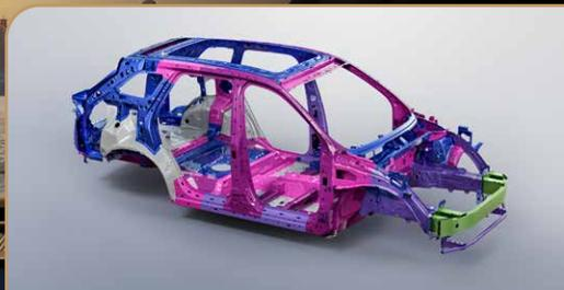
> **Estructura reforzada con aceros de alta resistencia**
