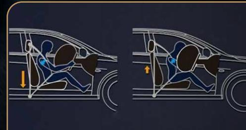
› **Cinturones de seguridad** de 3 puntos en todos los asientos y pretensados para mayor protección
