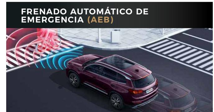
Permite mediante sensores ubicados en la parte frontal, monitorear las condiciones de tráfico, en caso de detectar obstáculos inesperados en frente, el TIGGO 8 PRO realiza un frenado de emergencia.
