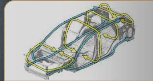
› **Chasis y carrocería reforzada** con aceros de alta resistencia **Benteler** para mayor efecto anticolidión
